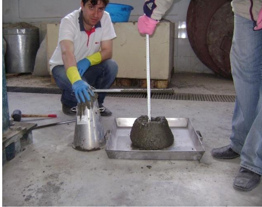
Şekil 4.2. Çökme deneyinin yapılışı
