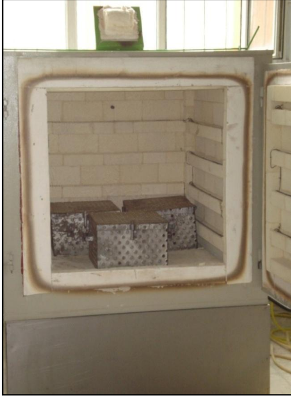
Şekil 4.7. Numunelerin ısıldığı fırın ve koruma kılıflarının görüntüsü
