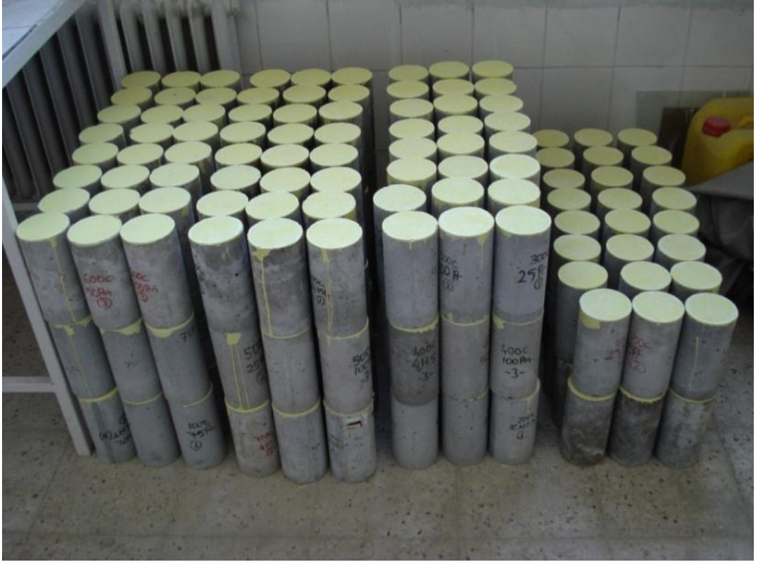
Şekil 4.5. Yüksek sıcaklıklardan sonra silindir numunelerin toplu görüntüsü
