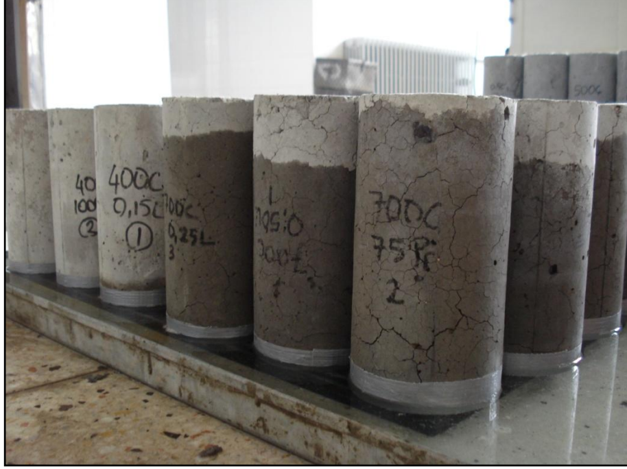
řekil 4.27. 400°C ve 700°C sıcaklıklara ısıtılmıř numunelerin geđirimsilik deneyi
