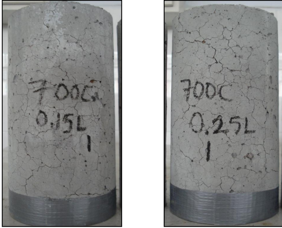
Şekil 4.31. 700°C sonrası lifli numunelerdeki çatlakların görüntüsü
