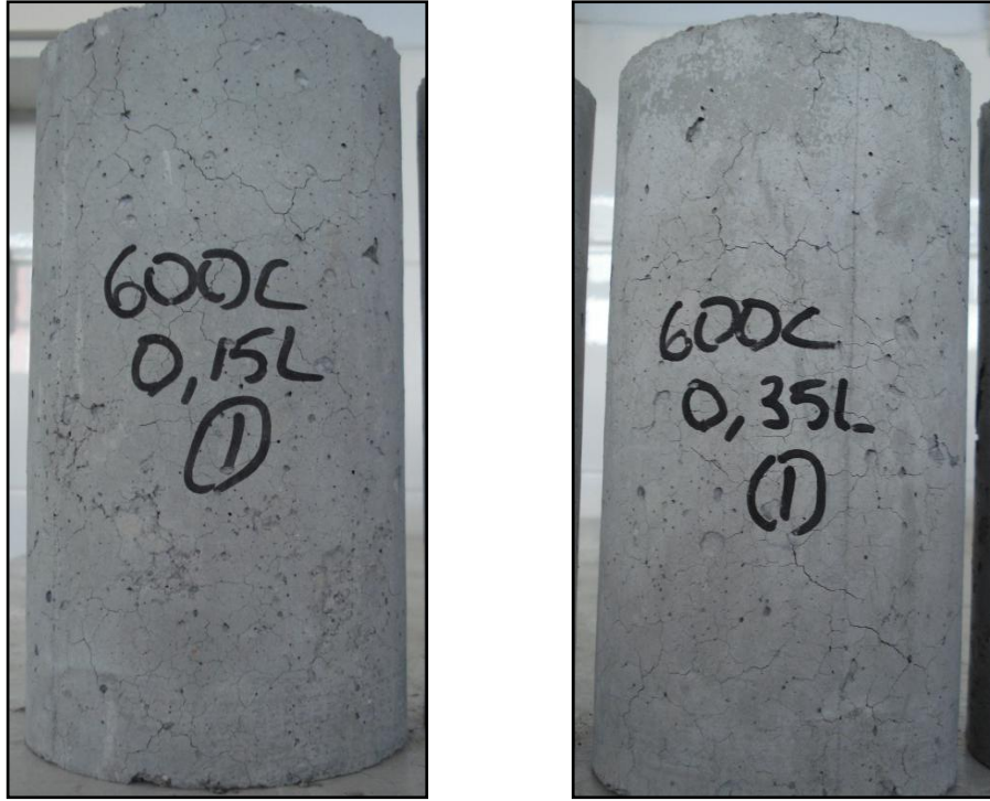
Şekil 4.30. 600°C sonrası lifli numunelerdeki çatlakların görüntüsü
