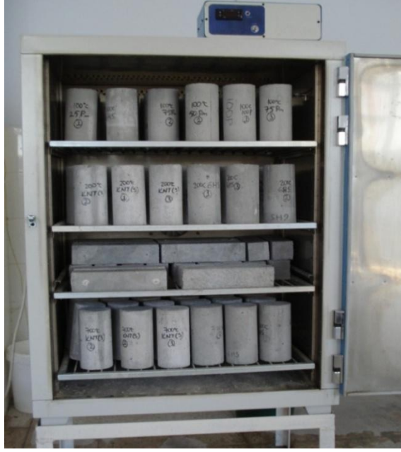
Şekil 4.6. Numunelerin etüvde kurutulması işlemi
