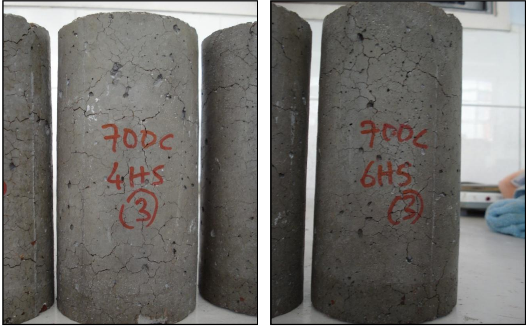
Şekil 4.33. 700°C sonrası hava sürükleyici katkılı numunelerdeki çatlakların görüntüsü
