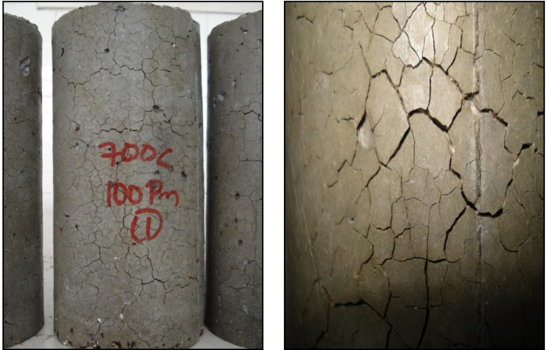
Şekil 4.25. 700°C sonrası pomzalı numunelerdeki çatlakların görüntüsü
