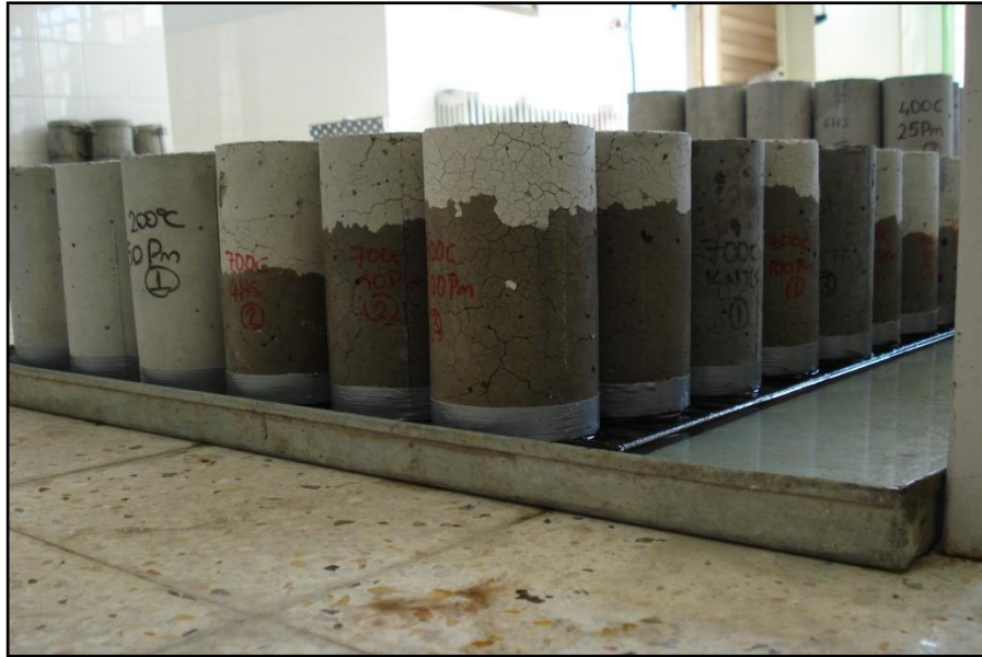
Şekil 4.23. 200°C ve 700°C sıcaklıklara ısıtılmış numunelerin geçirimlilik deneyi
