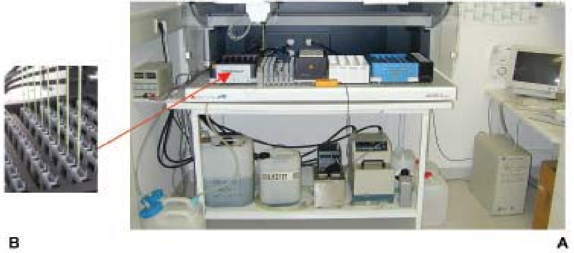
Şekil 3.21. Tecan Genesis platformu; in situ hibridizasyon yapmaya uygun şekli (A) Genesis RSP 150 platformu, (B) İki özel kaptan oluşur. Kapların her birisi 6 bölme içerir, her bir bölmede 8 tane slayt yerleştirilecek kısım vardır.
