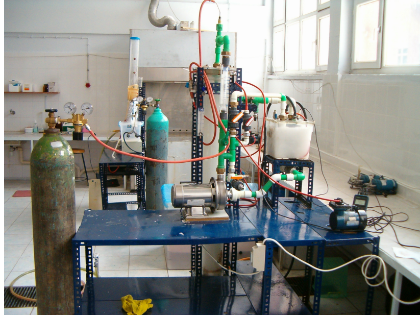
Şekil 3.3. K_L tespiti için yapılan bir deneme sırasında PQR'ün görünüşü
