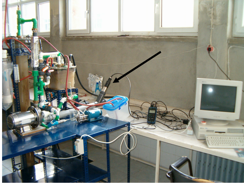
Şekil 3.9. PÇMB'ün fotoğrafı ve online bağlı MLSS ölçüm cihazının yerleşimi
