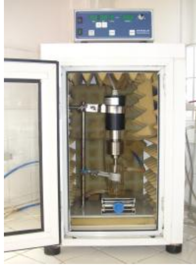
Şekil 3.5. 20 kHz Bandelin Sonolus HD220 ultrasases cihazı (Boğaziçi Üniversitesi Çevre Bilimleri Enstitüsü).
