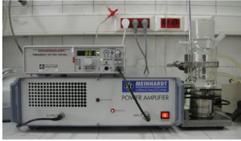
Şekil 3.6. Ultraschall çoklu frekans ultrases cihazı (Boğaziçi Üniversitesi Çevre Bilimleri Enstitüsü).
