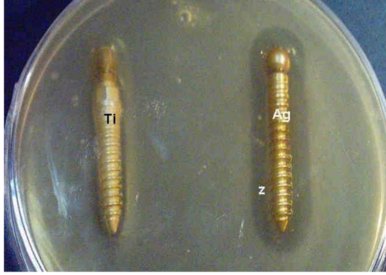
Resim 7: Gümüş kaplı olmayan (Ti) ve gümüş kaplı olan (Ag) implantın aynı agarda aynı bakteriye olan etkileri. Gümüş kaplı olmayan vidada inhibisyon zonunun (z) olmadığına ama gümüş kaplı vidada belirgin bir inhibisyon zonu olduğuna dikkat edin.
