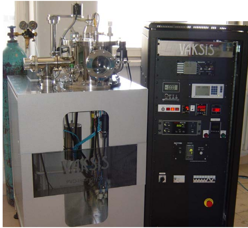
Şekil 4.1. VAKSiS Ar-Ge ve Mühendislik Şirketinden satın almış olduğumuz PVD-HANDY-3S, sputter ve termal buharlaştırma ünitesi Katıhal proses laboratuvarında kurulmuş ve çalışır vaziyette bulunmaktadır
