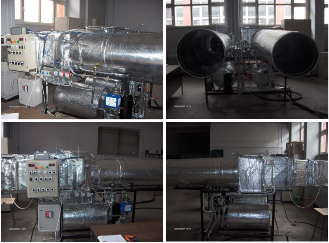
Şekil 3.2. Isı pompası deney sisteminin görünüşü
