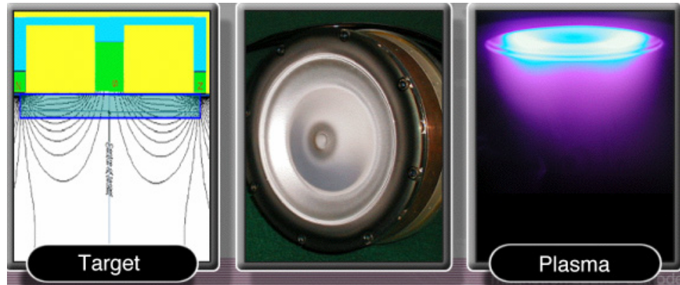
Şekil 2.6. Plazma bölgesi ve hedef metalin sıçratma işleminden sonraki erozyonu ( bama.ua.edu/~phx34/SP04/09SputterDeposition.ppt )
