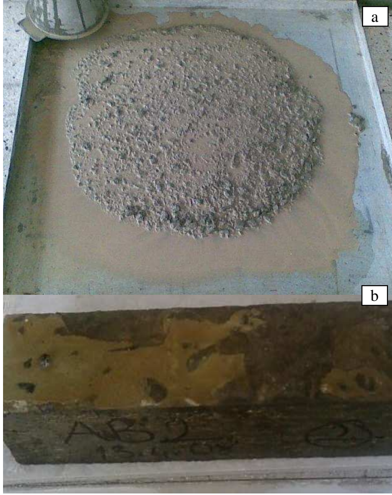
Şekil 4.6. AÇ'li karışımlarda görülen ayrışma (a: taze halde, b: sertleşmiş durumda)
