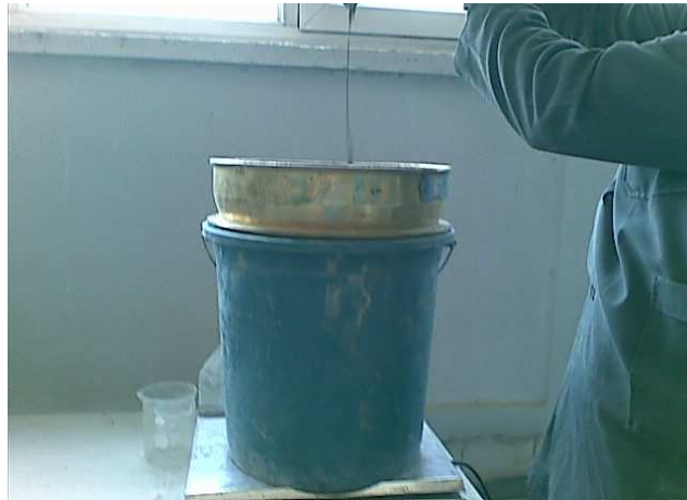
Şekil 3.4. Elek ayrışması deney düzeneği ve deneyin yapılması
