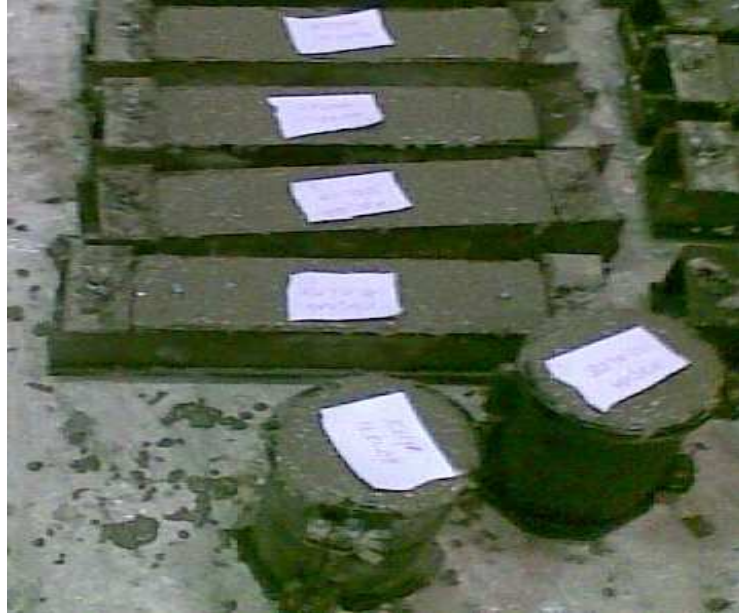
Şekil 3.5. Sertleşmiş beton deneyleri için üretilen numuneler
