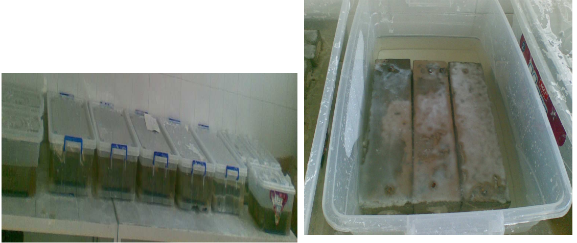
Şekil 3.6. Numunelerin %10 \text{Na}_2\text{SO}_4 çözeltisinde saklanması
