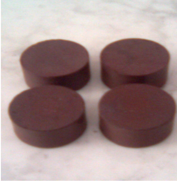
ekil 3.4. Hidrolik preste hazırlanan briketler
