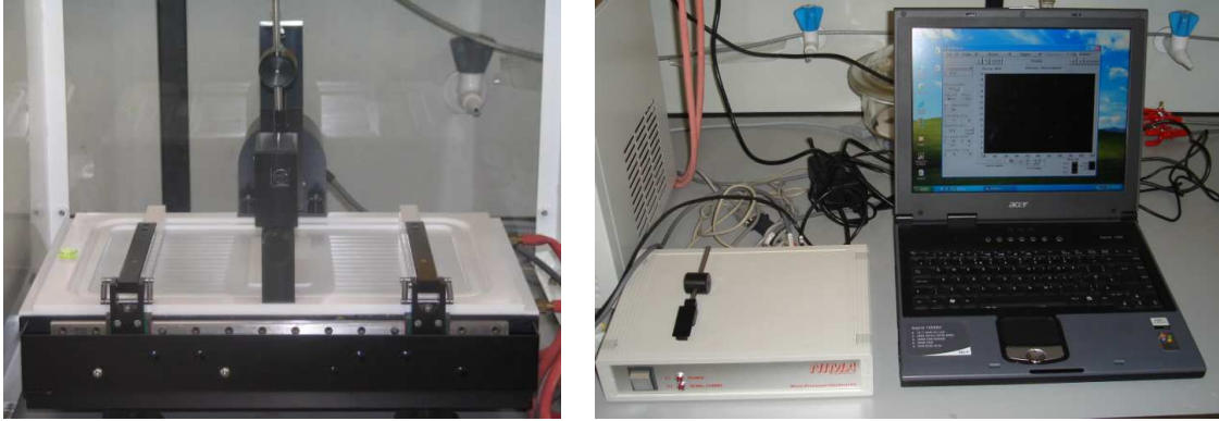
Şekil 3.1. Kullanılan LB sistemi (NIMA firmasına ait model 612D)
