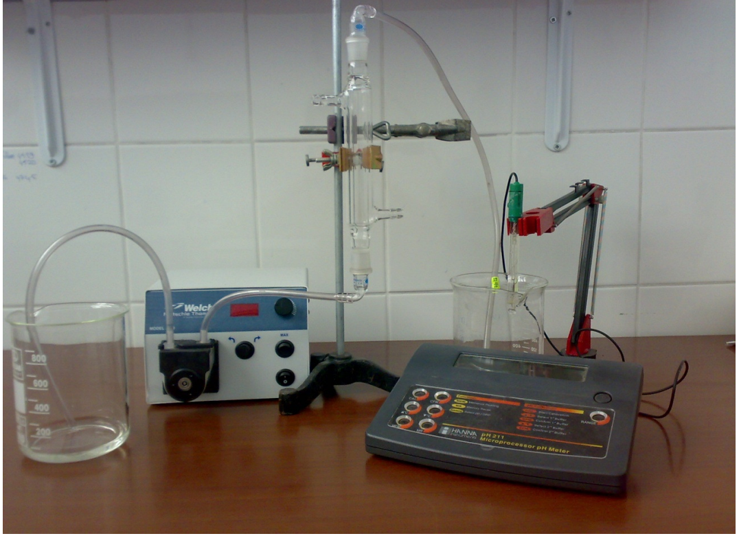
Şekil 3.10. Sürekli çalışmalarının yürütüldüğü kolon sistemi
