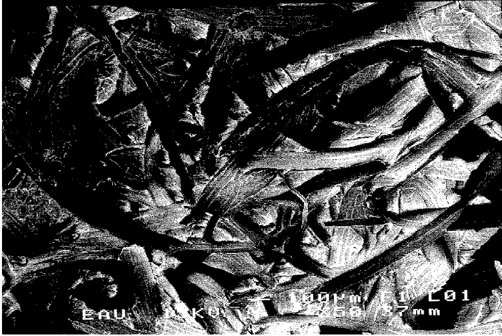
Şekil 4.55. Lifli atık çayın bakır gideriminden sonra SEM görüntüsü
