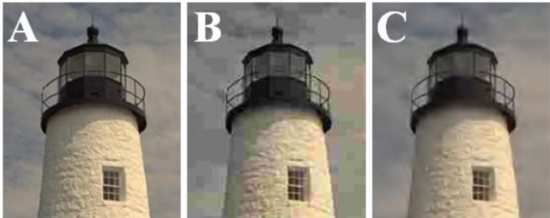
Şekil 5.18. A) Orijinal görüntü B) JPEG ile 1/100 oranında sıkıştırılmış görüntü C) JPEG2000 ile 1/100 oranında sıkıştırılmış görüntü
