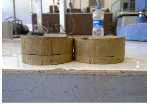
Şekil 5.27. Katkısız ve organokillere ait kesme kutusu deneyi yapılmış numuneler
