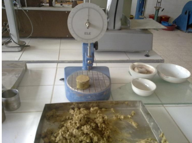
Şekil 4.12. Katkısız kil numunesine kıvam limitleri deneyleri yapılırken
