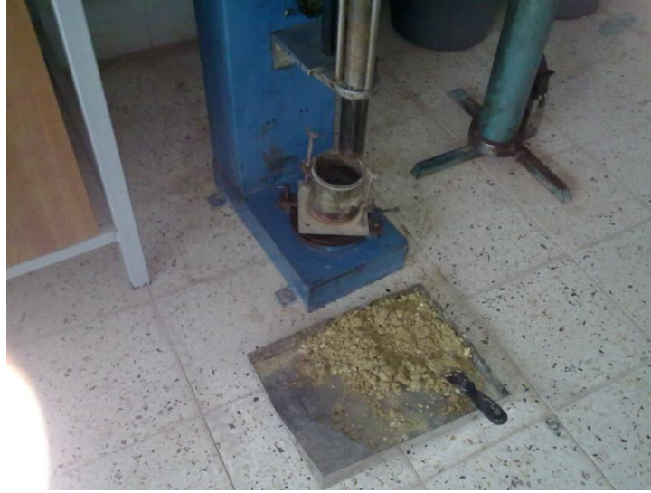
Şekil 4.13. Katkısız kil numunesine kompaksiyon yapılırken
