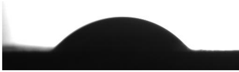
Şekil 5.4. Katkısız kil numunelerin Temas Açısı ( 35^\circ )
