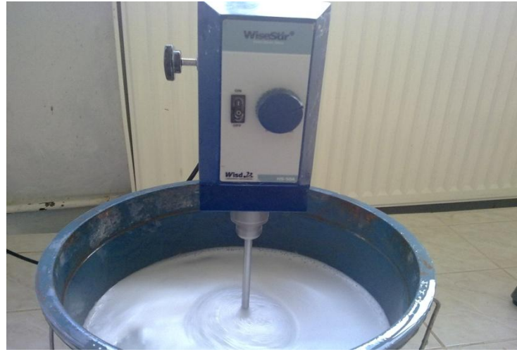
Şekil 4.8. CTAB–Kil süspansiyonunun hazırlanışı
