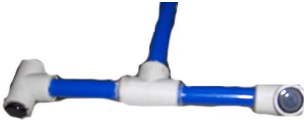
Şekil 1-20 Ultrasonik alıcı vericilerin bastona yerleştirilmiş hali [24]
