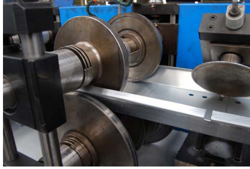
Resim 2.1 Rulo Halindeki Hafif Çeliğe Şekil Verilmesi (vefaprefabrik.com, 2009)
