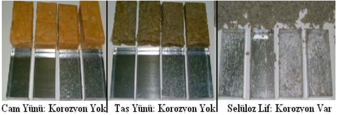
Resim 3.4 Yoğuşma Durumunda Yalıtım Malzemesinin Hafif Çelik Profile Etkisi (closerlookinspection.com., 2009)
