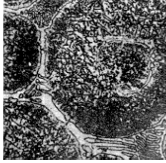
Şekil 5.1. Dökümden sonra hız çeliği. Ağ şeklindeki karbür ötektikumu
