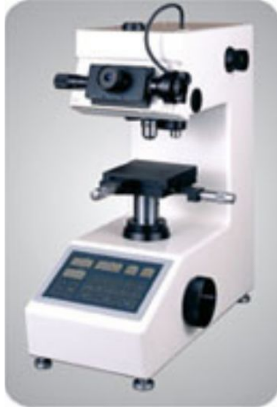
Şekil 6.1. Matzurama marka mikrosertlik ölçme cihazı (TÜBİTAK – GEBZE)
