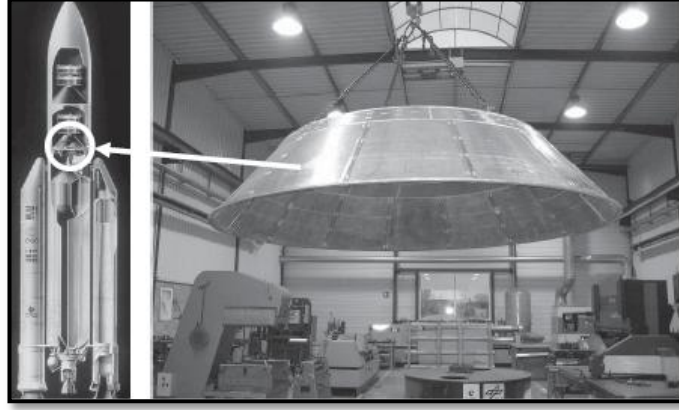
Şekil 2.7 Alüminyum köpük sandviçlerden üretilmiş prototip roket başlığı (Banhart vd., 2008)
