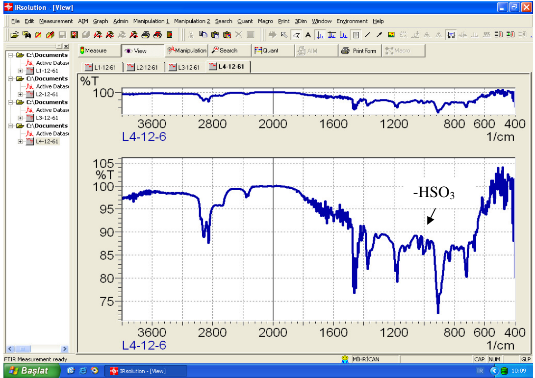
Şekil 3.6 %20 LABSA İçeren Piroliz Ürününün FT-IR Spektrumu
