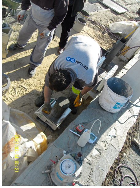
Resim 3.10. Taze Betonun Yoğunluğunun Belirlenmesi
