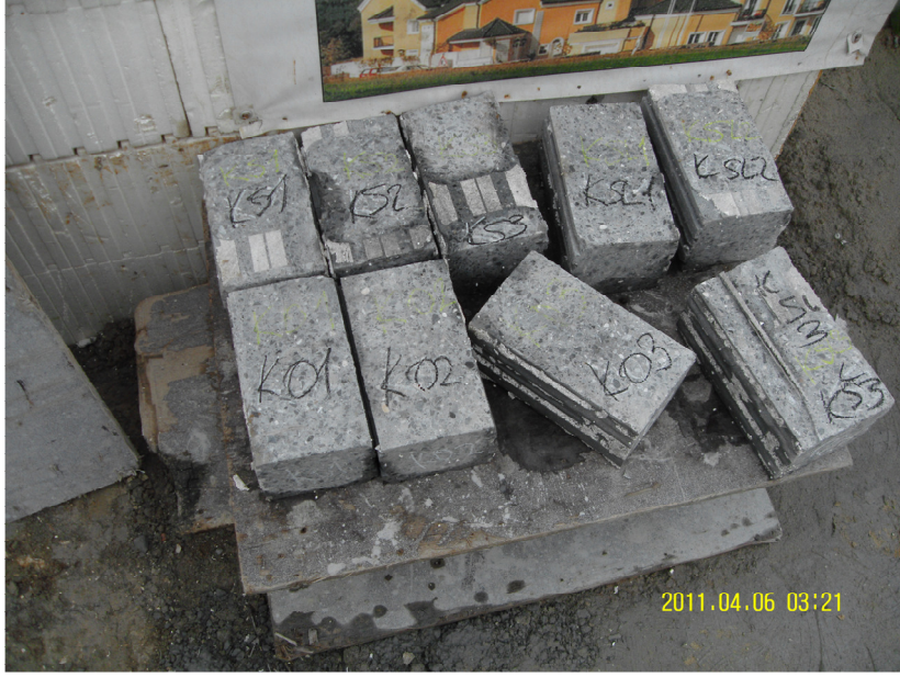
Resim 3.21. Duvar Numunelerinden Kesilerek Çıkarılmış Prizmatik Beton Numuneler
