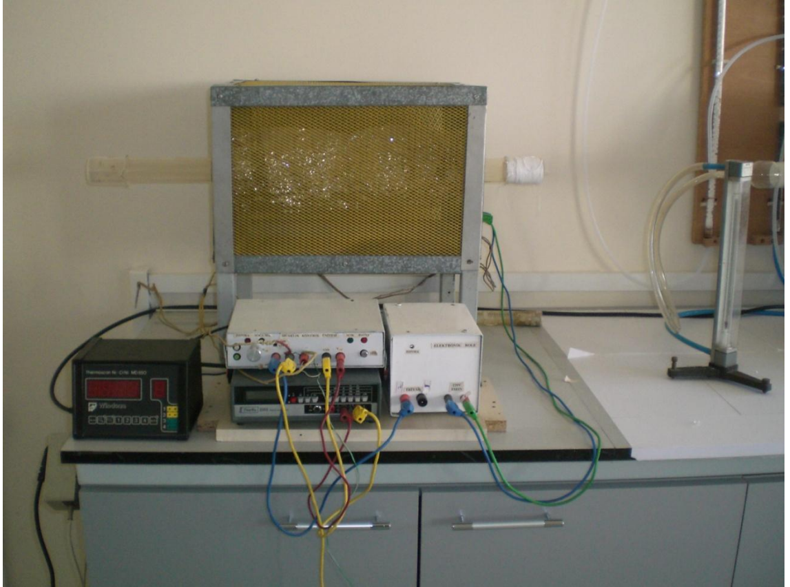
Şekil 3.5. Omik kontak yapmak için kullanılan tavlama fırını (Gürbulak 1998)
