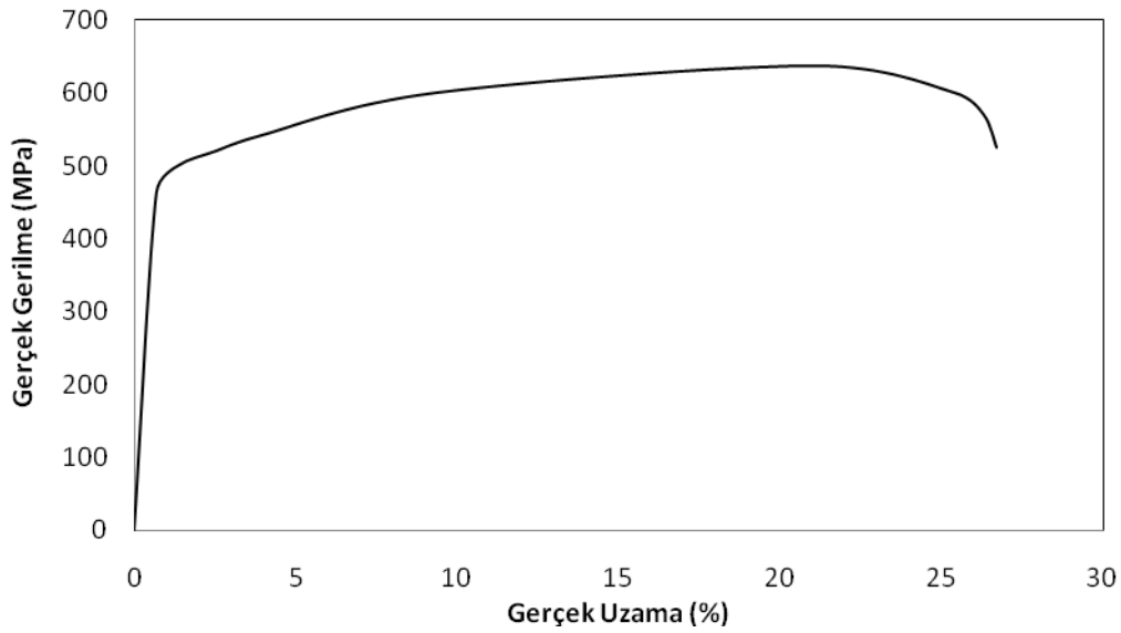
Şekil 3.1. Saf titanyumun Gerilme-Uzama diyagramı.
