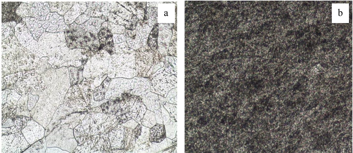
Şekil 4.4. EKA uygulanmamış (a) ve EKA uygulanmış (b) saf titanyumun dağlama sonrası elde edilen yüzey görüntüleri.
