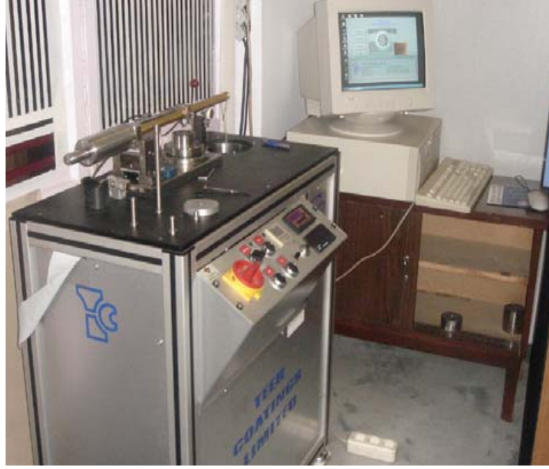
Şekil 3.8. Aşınma deney düzeneği.
