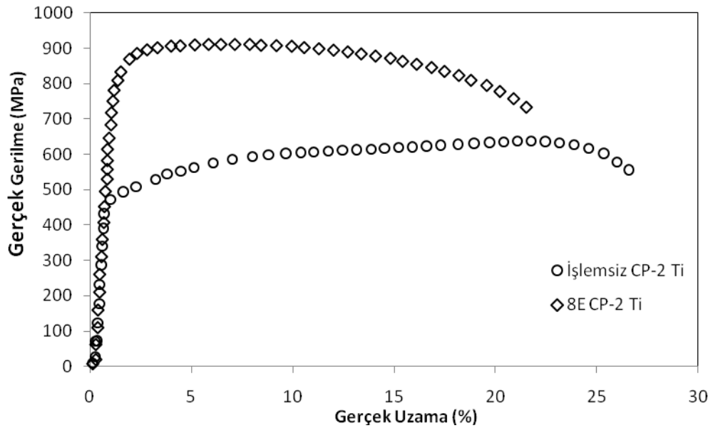
Şekil 4.8. Saf titanyumun EKAE işlemi öncesi ve sonrası gerilme-uzama diyagramı.
