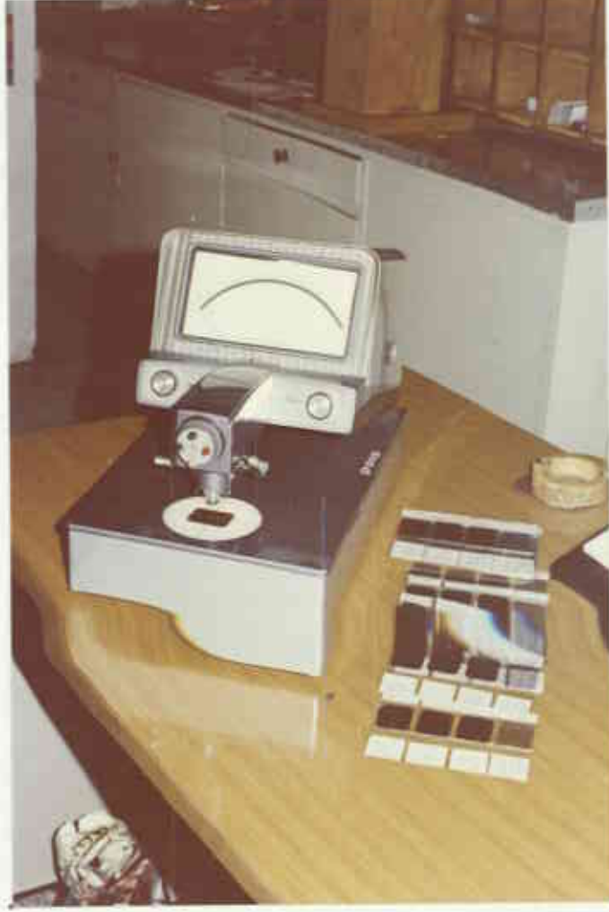
Resim: 9:Radiograflarımızdaki densite değerlerinin saptandığı densitometre cihazı.
