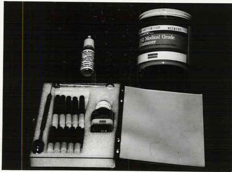
Resim 1) Çalışmamızda kullandığımız silikon kauçuk, katalizatörü, basınçlı şırınga ve iğneleri.
