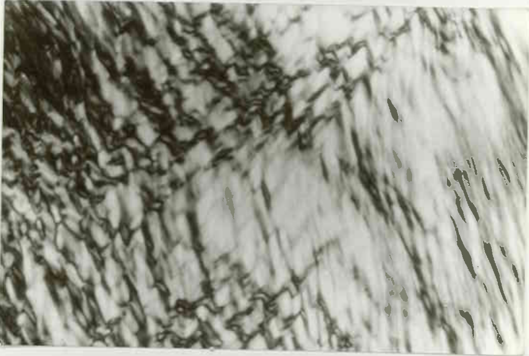
ŞEKİL 22: HEKZAGONAL FAZIN ÇİZGİLİ (STRIATED) YAPISI 20°C'DA BEKLETİLEN UNDESİLENİK ASİT-MİSİRÖZÜ YAĞI/SU/SİMULSOL 98 (5-15/40/40) SİSTEMİNDEN x143 BÜYÜTME İLE ÇEKİLMİŞTİR.
