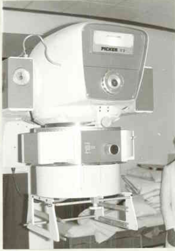
RESİM 2 : Picker V-9 Telekobalt aletinin baş kısmı.
