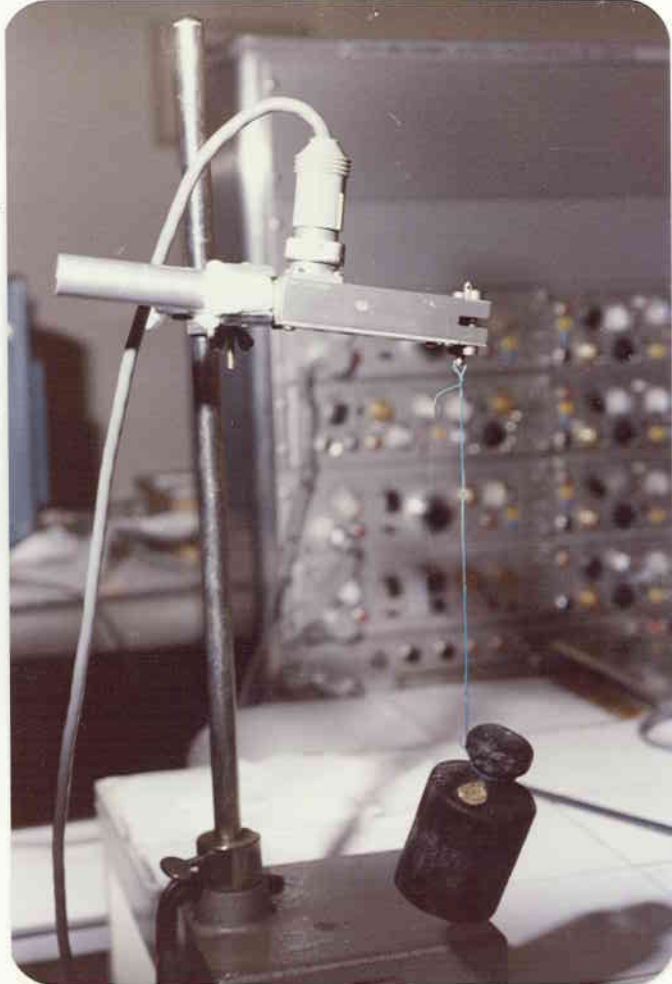
Resim 4-a : Transducer'in başlıklarına çeşitli ağırlıklar asılarak sistemin kalibre edilmesi.
