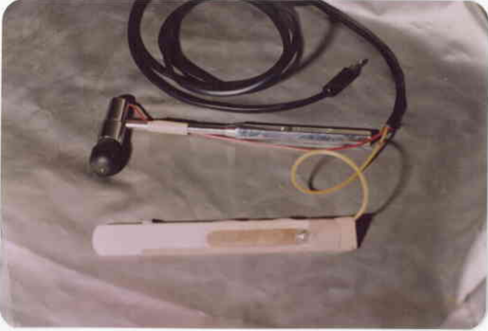
Resim 5: Hem sessiz dönemi, hem de EMG cihazının devresini kapatmak için yapılan düzenek.
