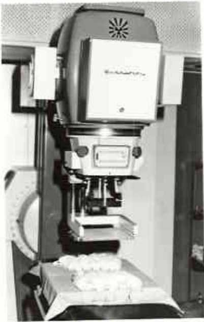
RESİM 3: Gammatron 3 kobalt-60 aygıtı ve hayvanların hedef masasındaki durumu.
