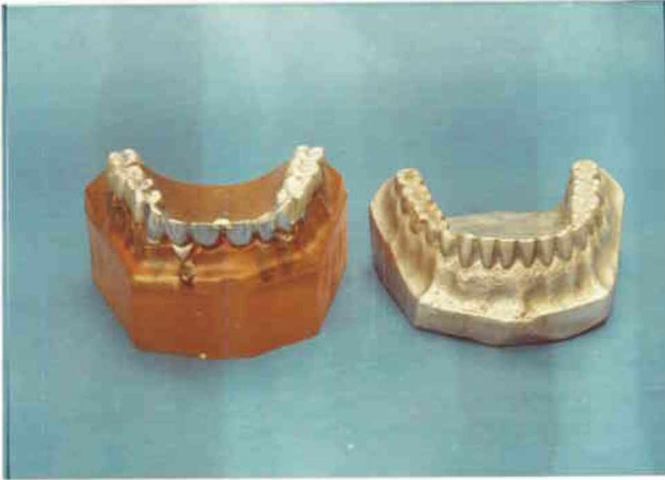
Resim-9: Fotoelastik model üzerinde köprü görünümü
