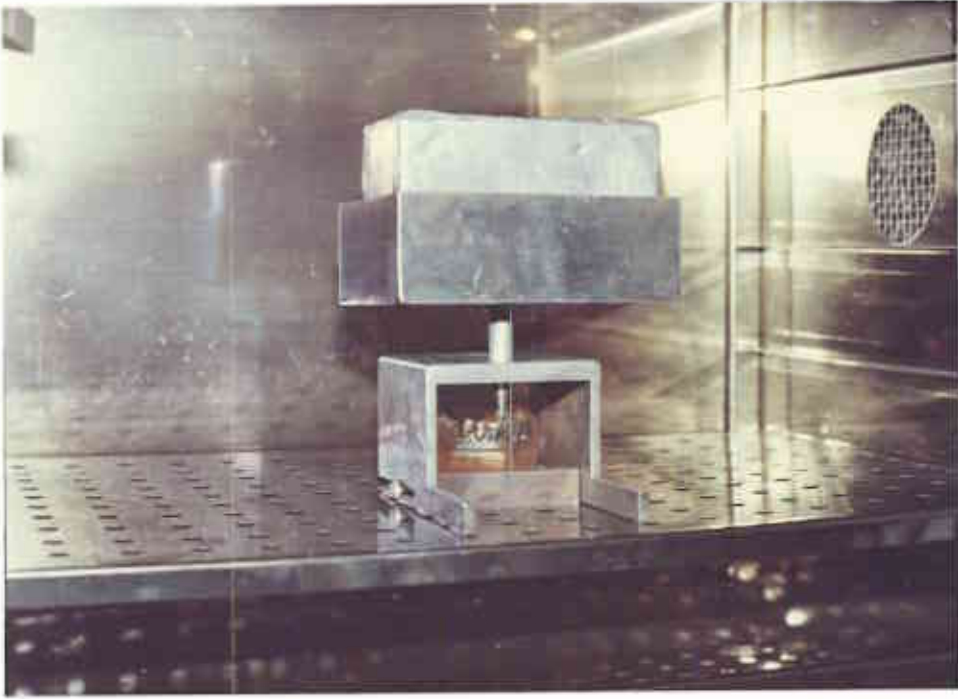
Resim-17: Kuvvet çizgilerinin dondurulması için kullanılan fırın ve uygulama durumundaki model.
