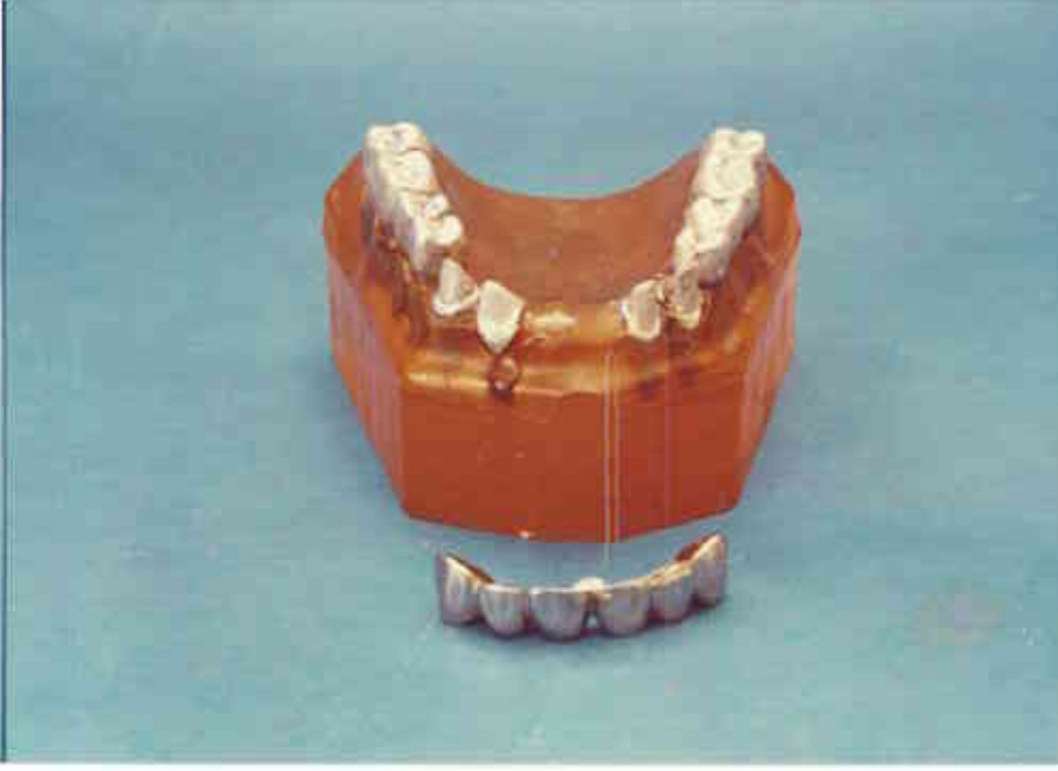
Resim-10: Fotoelastik model üzerinde köprünü görünümü
