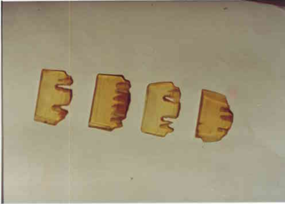
Resim-18: Fotoelastik modelden alınan kesitler.
