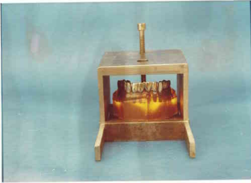
Resim-13: Takoz üzerine yerleřtirilen fotoelastik modelin görünümü.
