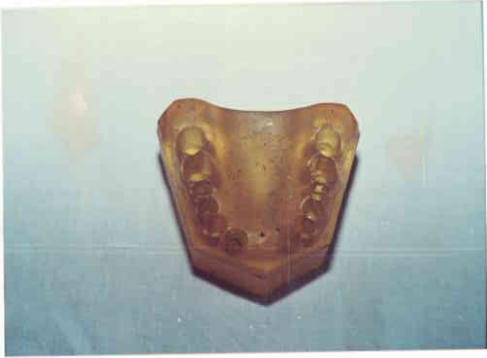
Resim-7: Fotoelastik ana model
