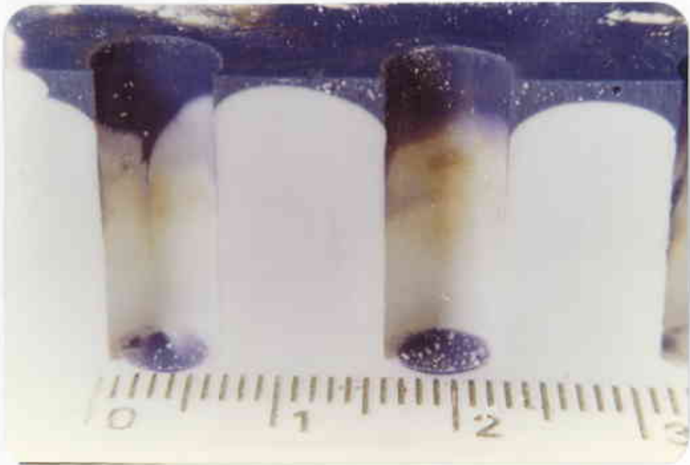
Resim 9: Tabakalı Tek Ölçü Yöntemi ile alınmış ölçüden kesit (x3).
