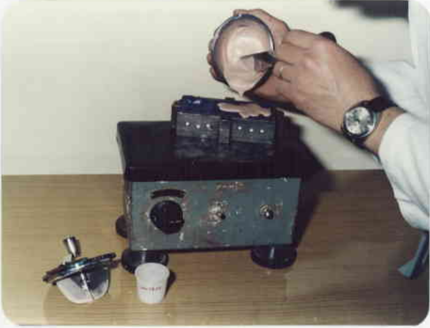
Resim 10: Ölçülere, vibratör yardımı ile sert alçı dökülmesi.
