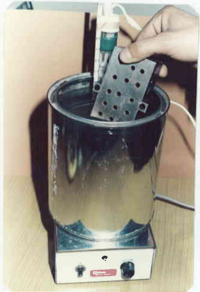
Resim 5: Deneyde kullanılan sabit ve homojen ısılı su banyosu düzeneği.
