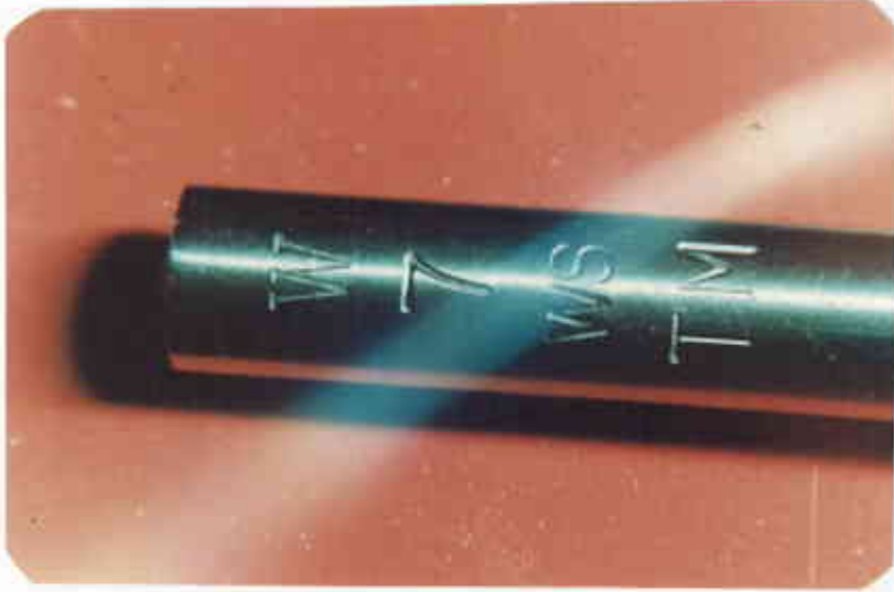
Resim 1:Master day olarak kullanılan 7,000mm. çaplı çelik matkap ucu.(x3)
