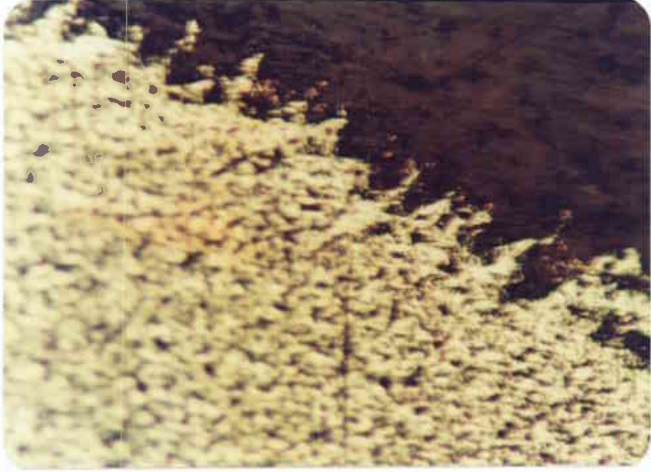
Resim 17 : Çekme kuvveti deneyleri sonucu en iyi bağlanma sağlanan pürüzlendirme tekniği ile elde edilen çukurcukların derinliği (x100).
