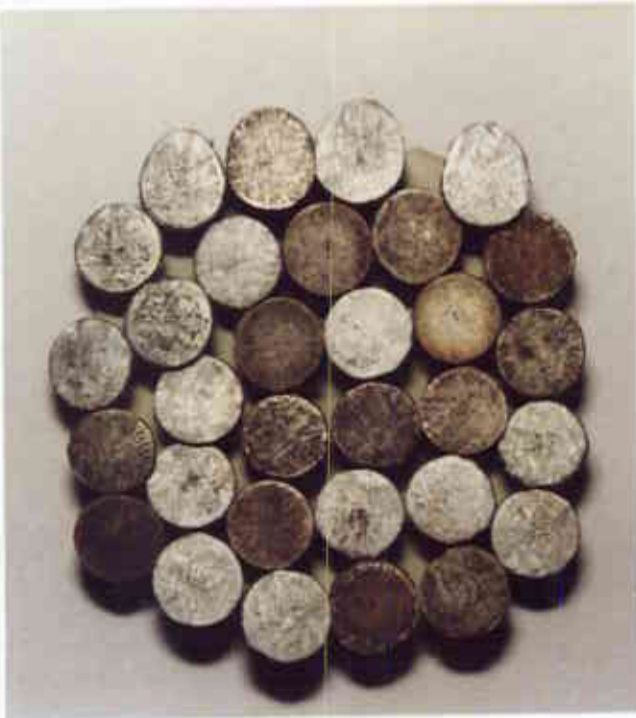
Resim 10 : Metal numunelerin pürüzlendirmeden sonraki görünüşleri.
