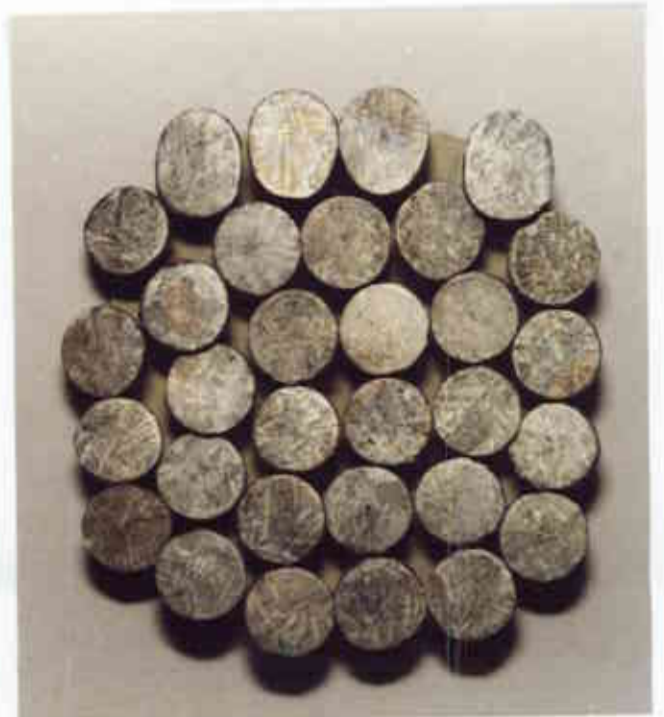
RESİM 11 : Resim 10'daki numunelerin ultrasonik karıştırıcıda temizlenmiş hali.
