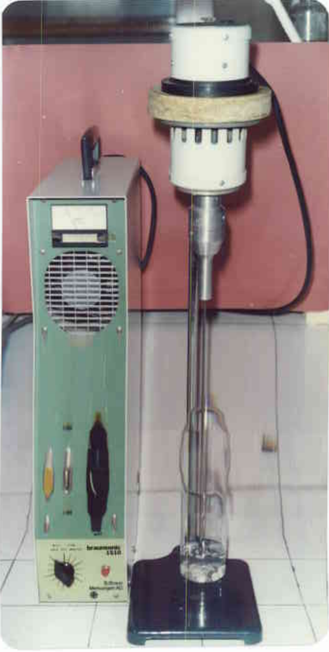
Resim 9 : Ultrasonic karıştırıcı (temizleyici).
