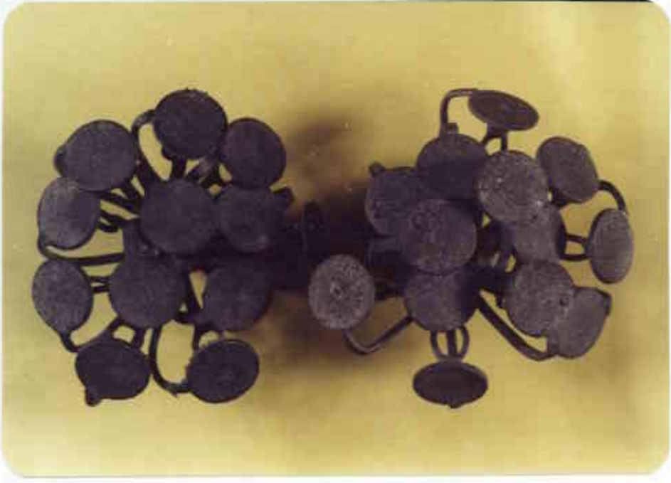
Resim 4 : Dökümden çıkmış numuneler.
