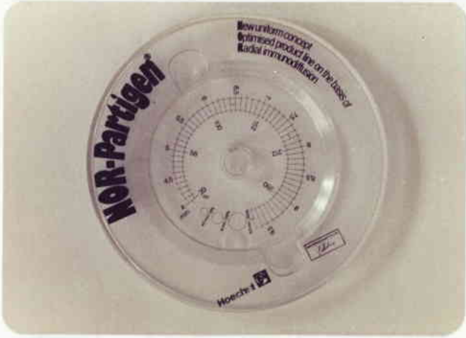
ŞEKİL 5 : PRESİPİTASYON HALKALARININ ÖLÇÜMÜNDE KULLANILAN CETVEL
