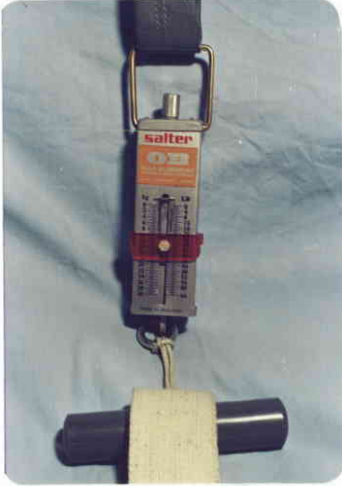
RESİM 4 : Araştırmamızda kullanılan Salter OB Reh. Prod. AB Firmasının 100 51 dinamometresi.
