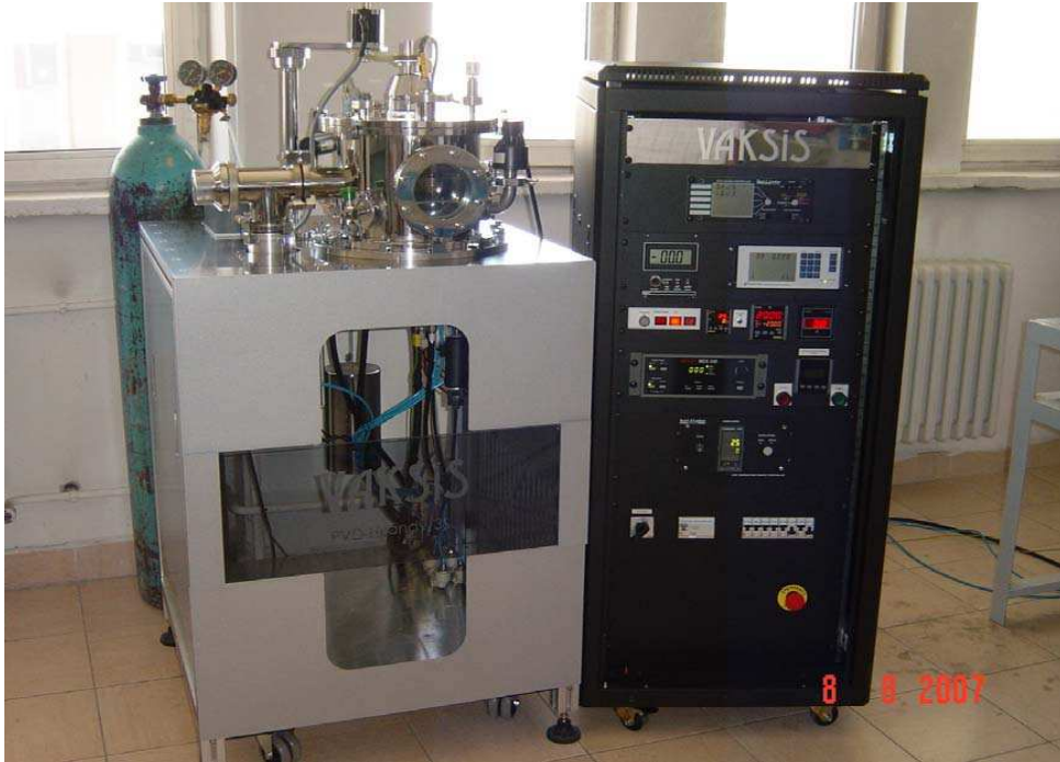
Şekil 3.1 PVD-HANDY-3S, sputter ve termal buharlaştırma ünitesi.
