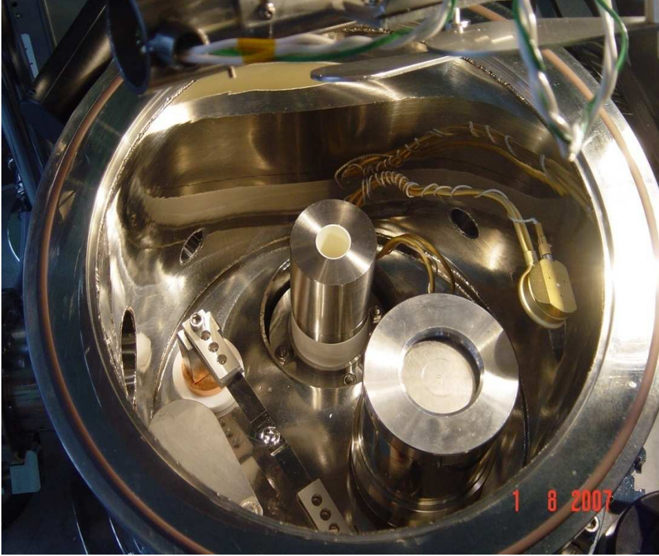
Şekil 3.2. PVD-HANDY-3S vakum sisteminin iç kısmının üstten görünüşü.
