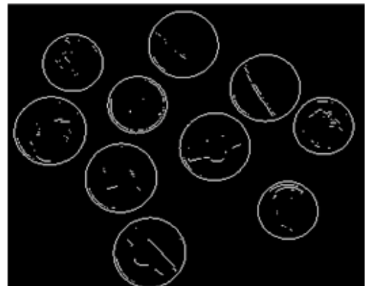
Şekil 2.15. Kenar tespit algoritması örneği (a) Kenar tespiti uygulanacak resim (b) Sobel operatörü ile kenar tespiti [8]
