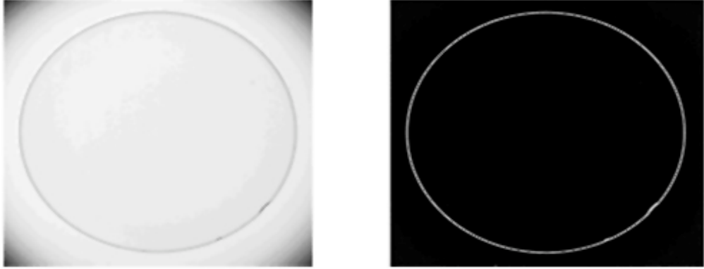
Şekil 2.11. Kenar tespit uygulama örneği (a) Hatalı üretilmiş kontak lens görüntüsü (b) Resmin sobel filtresi ile kenar görüntüsü [8]
