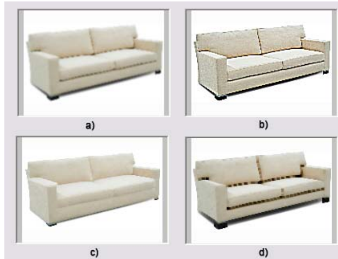
Şekil 4.9. Kanepenin üzerine uygulanmış filtreler (a) bulanıklaştırma filtresi, (b) keskinleştirme filtresi, (c) maksimum filtresi, (d) minimum filtresi
