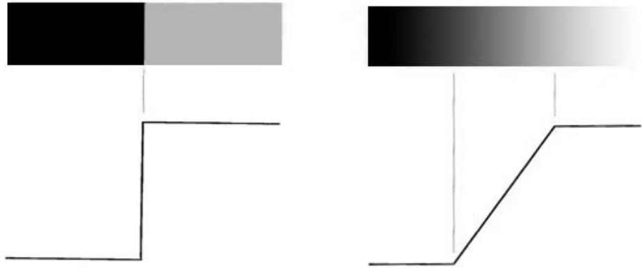
Şekil 2.12. Resimde kenar geçişi (a) Kusursuz kenar (b) gri tonlar arası rampa kenar
