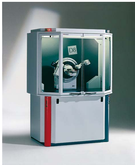
Şekil 2.3 X-Işınları Toz Difraksiyon Ölçümleri (XRD) İçin Kullanılan Bruker AXS D8 Advance Tipi Difraktometre.
