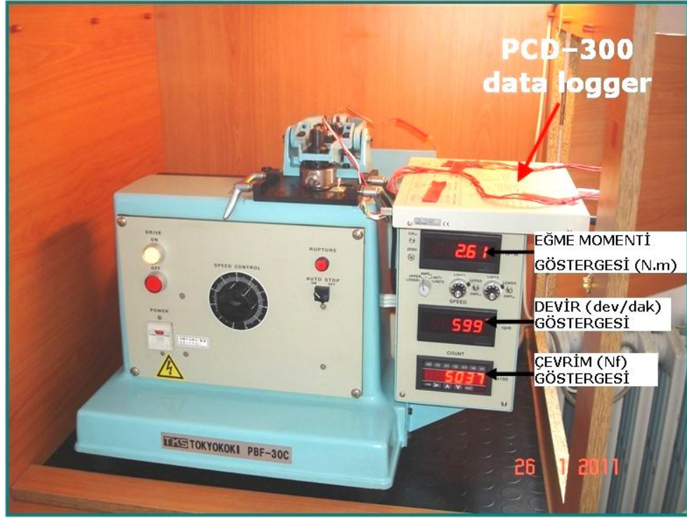
Şekil 3.9. Fretting test sistemli düz eğilmeli yorulma test ünitesinin fotoğraf görüntüsü.
