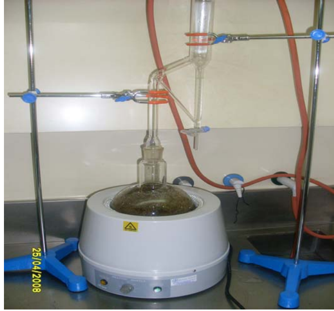
Şekil 2.1. Clevenger tip su buharlı distilasyon cihazı.
