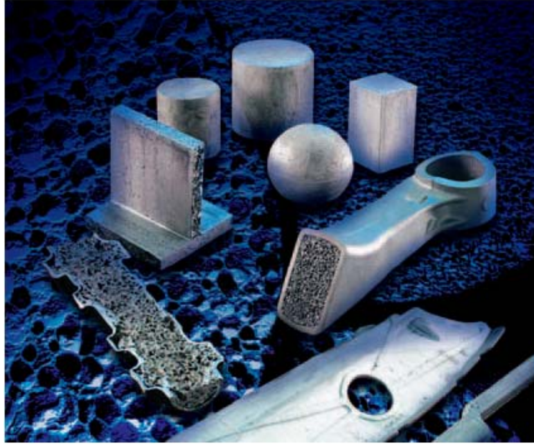
Şekil 3.13. Alüminyum ile kaplanmış alüminyum köpük [34].
