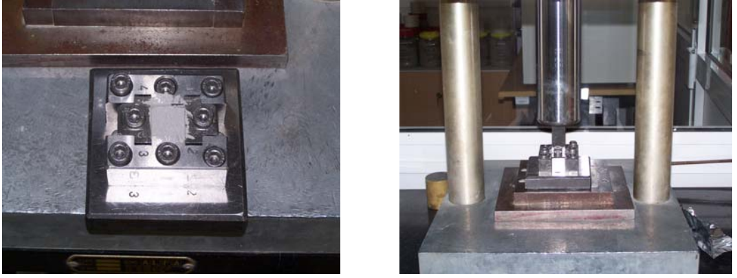
Şekil 5.30. Numunelerin basıldığı kalıp ve hidrolik pres.
