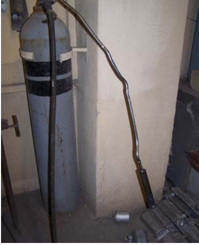
Şekil 5.3. Deney düzeneğinde kullanılan argon gazı tüpü ve homojen gaz çıkışı sağlayabilmek için kullanılan çok delikli uç.
