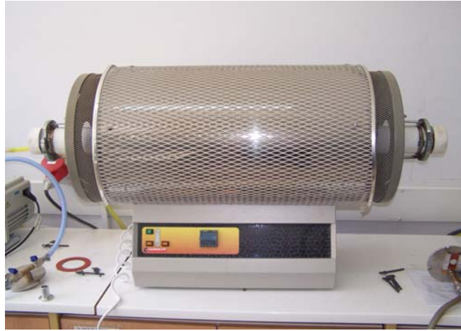
Şekil 5.32. Isı ve zaman kontrollü fırın.
