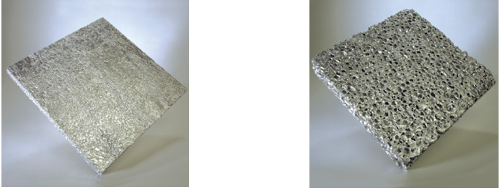
Şekil 3.2. Farklı yoğunluk ve gözenek büyüklüğündeki iki adet köpük slab [15].
