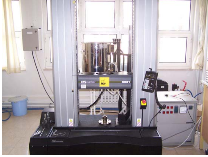
Şekil 5.23. Basma testinde kullanılan instron marka mekanik test cihazı (Anadolu Üniversitesi)
