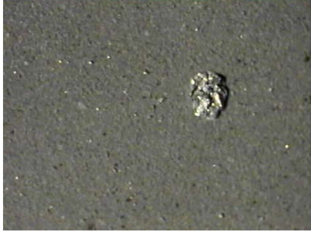
Şekil 5.35. 2A nolu numunede oluşan alüminyum fişkırması.
