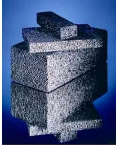
Şekil 3.19. Boşluk tutucularla üretilen alüminyum parçalar [43].
