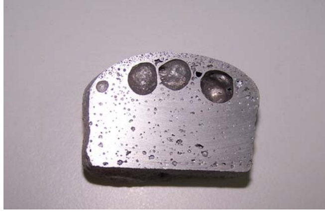
Şekil 5.71. Kabarcıklandırıcı maddelerle üretilmiş 48 nolu numuneye ait gözenekli yapı.
