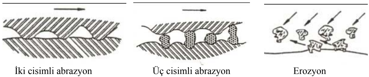
Şekil 5.88. Abrazyon aşınma mekanizmaları [73].
