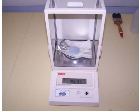
Şekil 5.27. Hassas terazide alüminyum ve TiH_2 tozunun tartılması.
