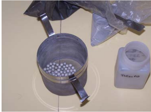
Şekil 5.28. Saf Alüminyum ve TiH_2 tozları ve 5 mm çapındaki zirkonyum bilyalar.
