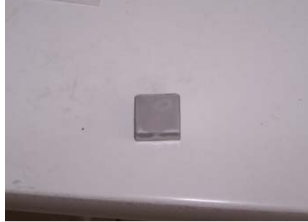
Şekil 5.31. Hidrolik presde basılan numune.
