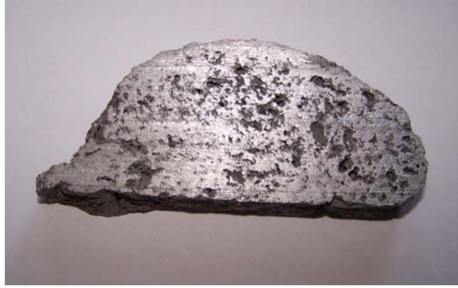
Şekil 5.6. Ham parçalardan elde edilen numune kesiti.
