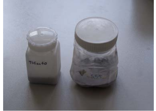
Şekil 5.28. Saf Alüminyum ve TiH_2 tozları ve 5 mm çapındaki zirkonyum bilyalar.
