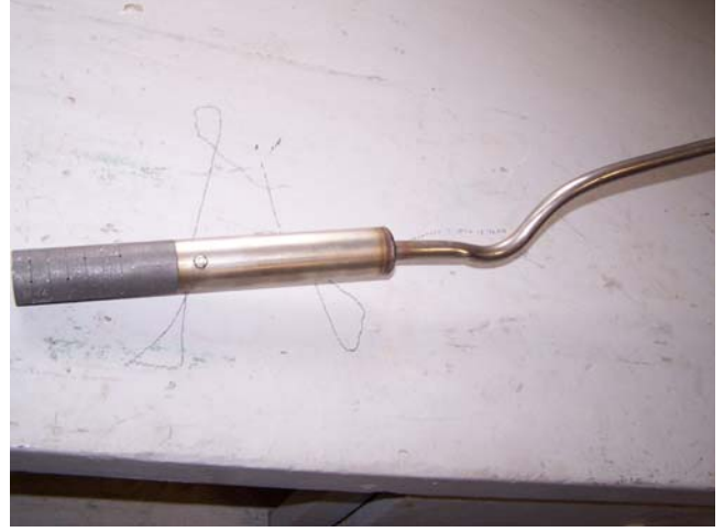
Şekil 5.3. Deney düzeneğinde kullanılan argon gazı tüpü ve homojen gaz çıkışı sağlayabilmek için kullanılan çok delikli uç.
