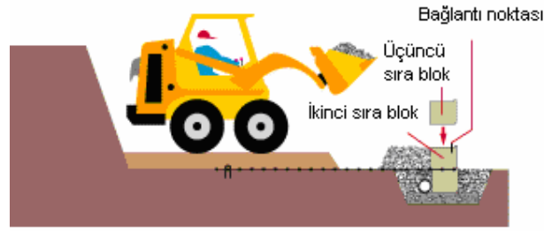
Şekil 4.9. Donatılı Duvar Blok Yerleştirilmesi.
