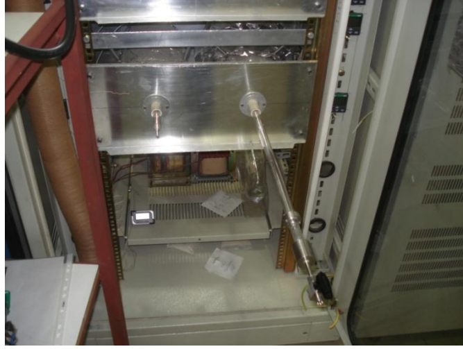
Şekil 3.2 Isıl işlem fırını *Atatürk Üniversitesi Nano Teknoloji Laboratuvarı
