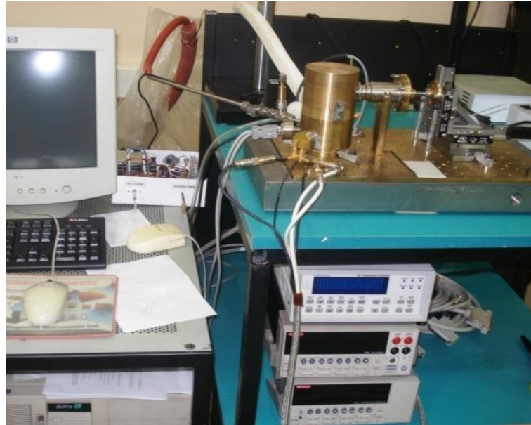
Şekil 3.4 Akım-Gerilim ölçüm sistemi *Atatürk Üniversitesi Nano Teknoloji Laboratuvarı
