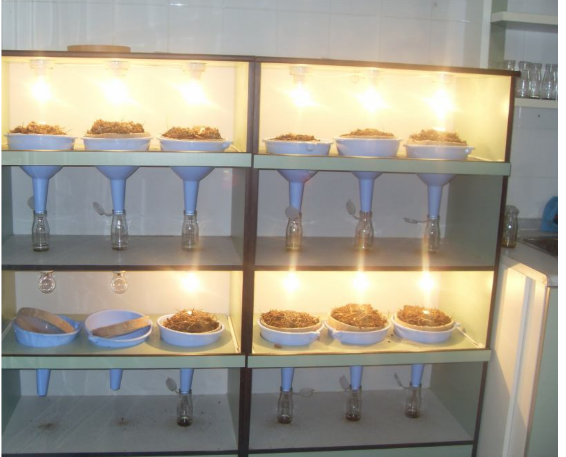
Şekil 2.2. Birleştirilmiş Berlese hunilerinden oluşan toprak akarlarını ayıklama düzeneği.
