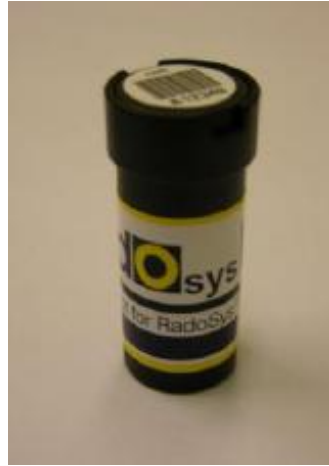
Şekil 3.1. RSKS tipi CR-39 radon dedektörünün difüzyon kabı
