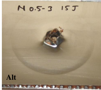
Şekil 4.4. Levha kalınlığı 0,5 mm olan sandviç yapının 15 J'lük darbe enerjisine karşılık elde edilen, kuvvet-zaman, kuvvet-deplasman, enerji-zaman grafikleri ile sandviç yapının üst, alt ve kesit resimleri
