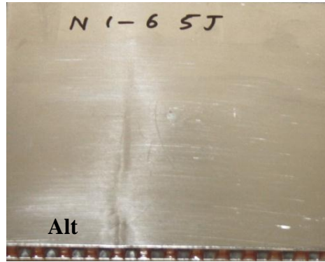
Şekil 4.9. Levha kalınlığı 1 mm olan sandviç yapının 5 J'lük darbe enerjisine karşılık elde edilen, kuvvet-zaman, kuvvet-deplasman, enerji-zaman grafikleri ile sandviç yapının üst, alt ve kesit resimleri
