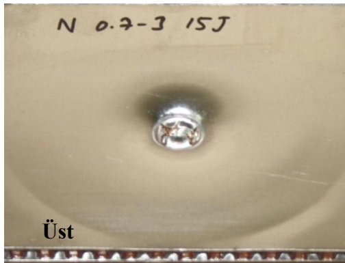
Şekil 4.7. Levha kalınlığı 0,7 mm olan sandviç yapının 15 J'lük darbe enerjisine karşılık elde edilen, kuvvet-zaman, kuvvet-deplasman, enerji-zaman grafikleri ile sandviç yapının üst, alt ve kesit resimleri
