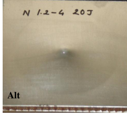
Şekil 4.17. Levha kalınlığı 1,2 mm olan sandviç yapının 20 J'lük darbe enerjisine karşılık elde edilen, kuvvet-zaman, kuvvet-deplasman, enerji-zaman grafikleri ile sandviç yapının üst, alt ve kesit resimleri
