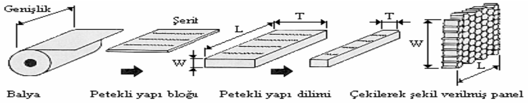
Şekil 2.6. Uzatarak şekil verme yöntemi
