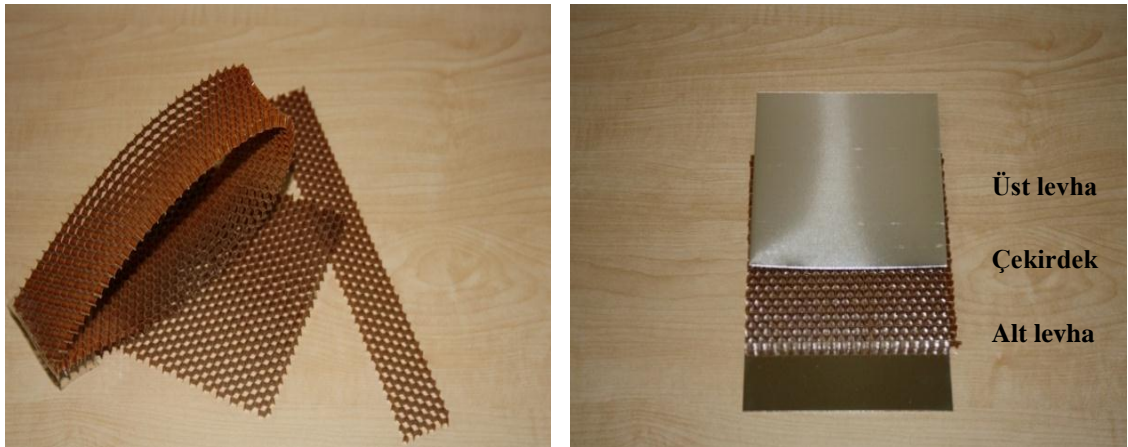
Şekil 3.7. Sandviç yapıyı oluşturan elemanlar
