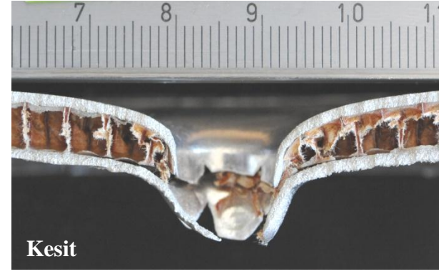
Şekil 4.13. Levha kalınlığı 1 mm olan sandviç yapının 35 J'lük darbe enerjisine karşılık elde edilen, kuvvet-zaman, kuvvet-deplasman, enerji-zaman grafikleri ile sandviç yapının üst, alt ve kesit resimleri
