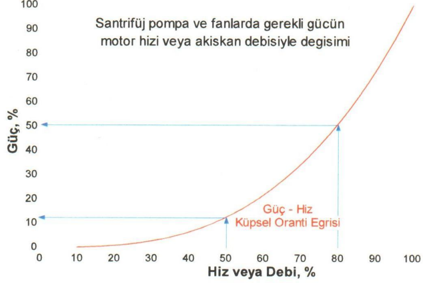
Şekil 2.28. Santrifüj pompa ve fanlarda gerekli gücün motor hızı ve akışkan debisiyle değişimi.
