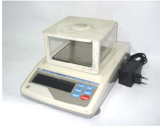
Őekil 3.19. Alařımı oluřturan metallerin tartılmasında kullanılan hassas terazi.
