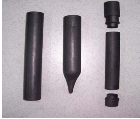
Şekil 3.15. Grafitten yapılmış olan pota, huni ve numune kalıbının fotoğrafı.
