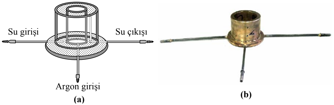
Şekil 3.6. Pirinçten yapılan soğutma kapağının (a) Şematik gösterimi, (b) Fotoğrafi.
