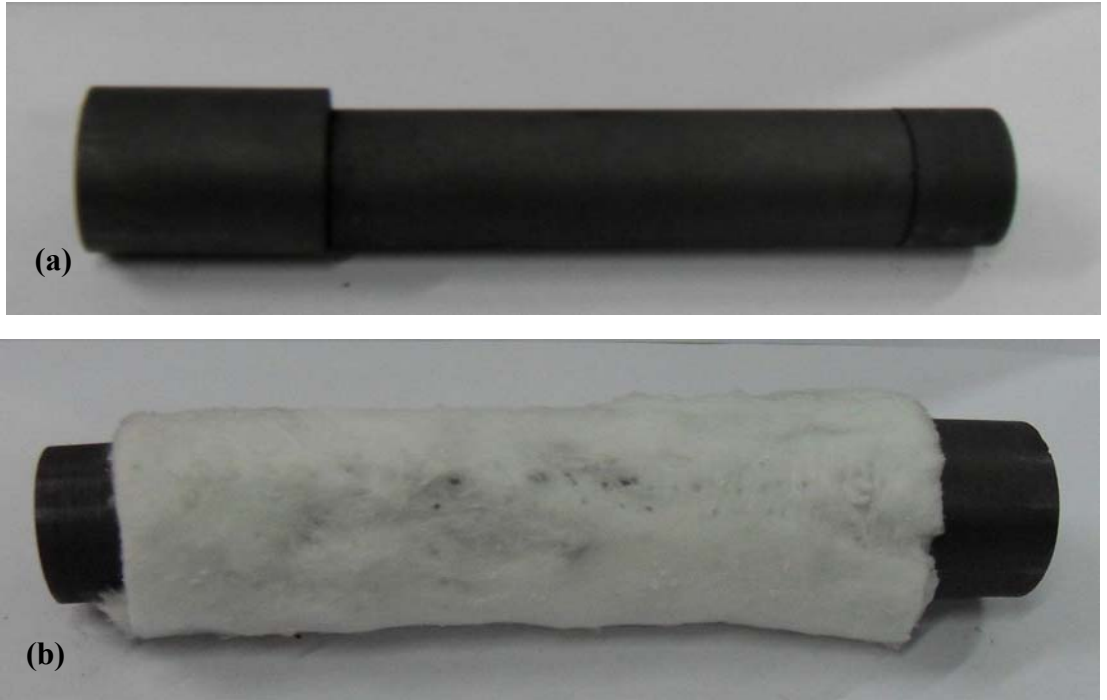
Şekil 3.18. (a) Döküm fırınına yerleştirilmek üzere hazırlanan ve (b) etrafına cam pamuğu sarılan numune kalıbının fotoğrafı.
