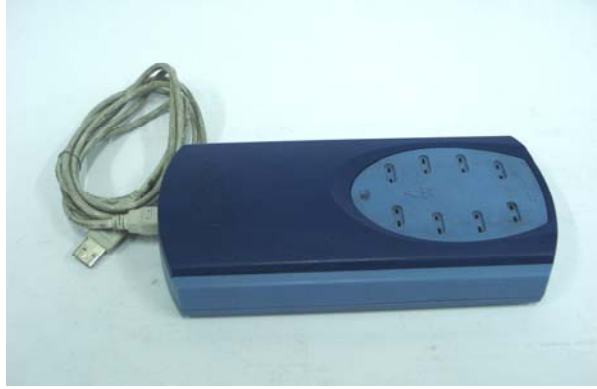
Şekil 3.24. Sıcaklık değişimlerinin kaydedilmesinde kullanılan Pico TC-08 model sıcaklık kaydedicisi.
