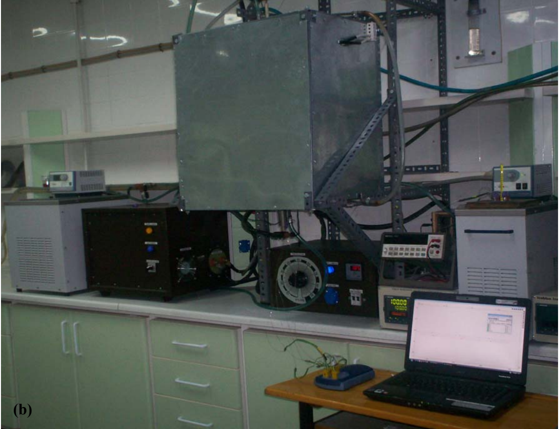
Şekil 3.3. Radyal ısı akış sisteminin (a) Blok diyagramı, (b) Fotoğrafi.
