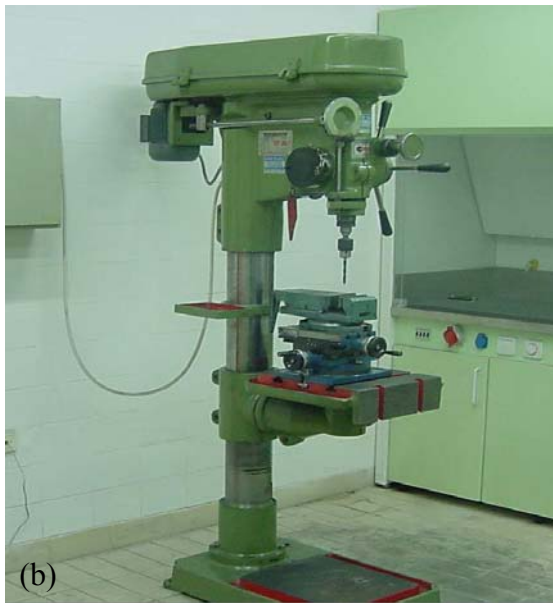
Şekil 3.17. Numune yapımında kullanılan aletlerin fotoğrafları. (a) Torna tezgahı, (b) Sütunlu matkap, (c) Masaüstü matkap.
