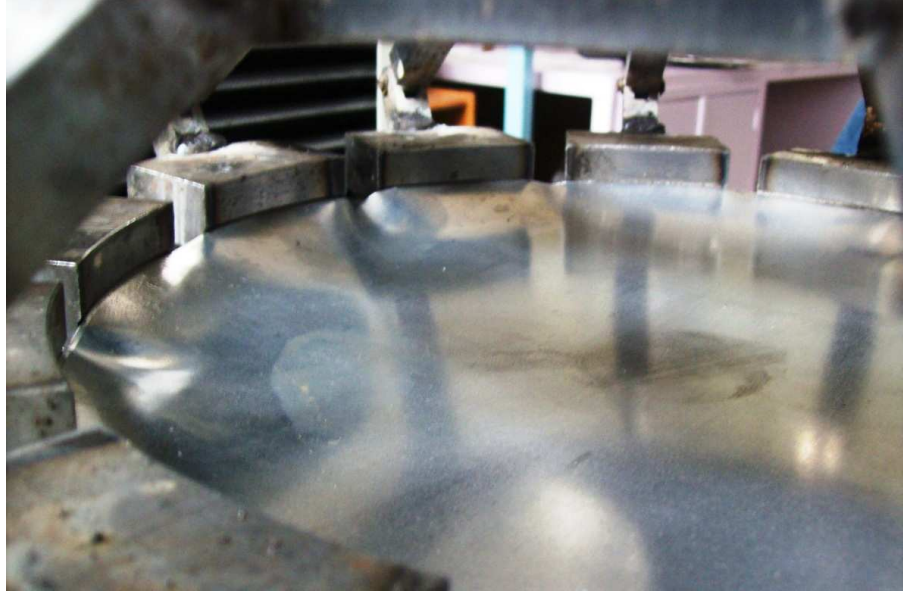
Şekil 3.30 Deney sırasında burkulunan dairesel plak
