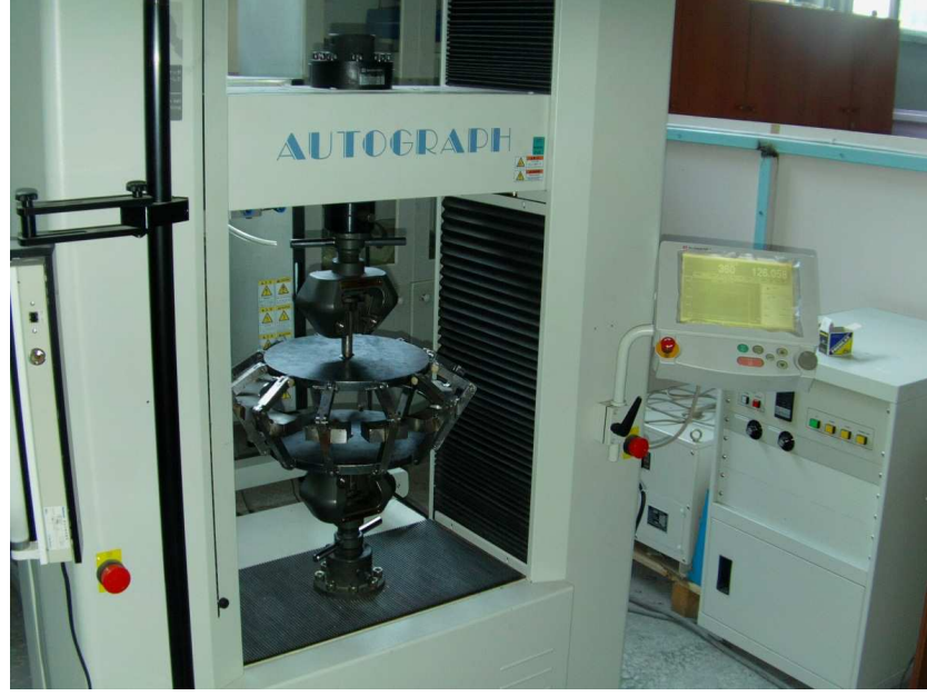
Şekil 3.29 Çekme cihazı ve deney aparatı fotoğraf görüntüsü
