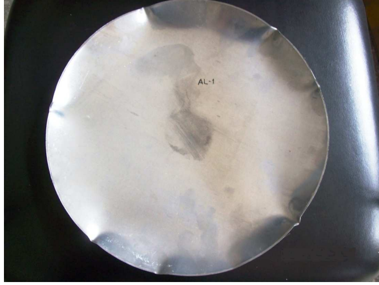
Şekil 3.31 Deney sonunda deformasyona uğramış alüminyum dairesel plak görüntüsü
