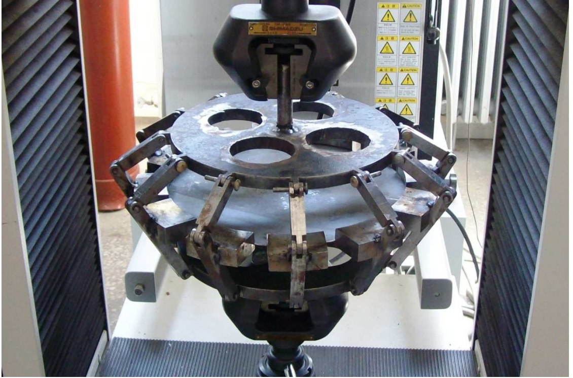
Şekil 3.22 Burkulma aparatının çekme cihazındaki görünüşü
