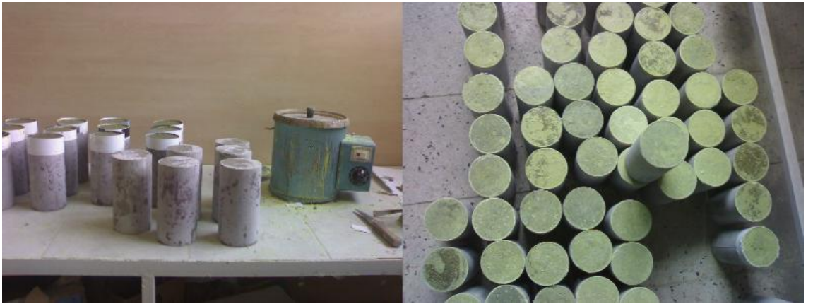
Şekil 3.11. a. Basınç dayanımı tayini için kükürtle başlıklanmaya hazır numuneler b. Başlıklanmış numuneler
