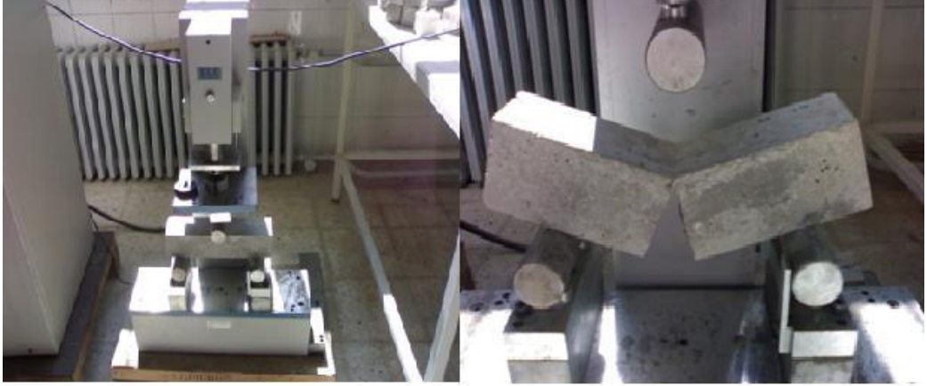
Şekil 4.8. a. Eğilme dayanımı tayini için hazırlanmış numune b. Eğilme dayanımı ölçüm deneyi sonrası beton numune görünümü
