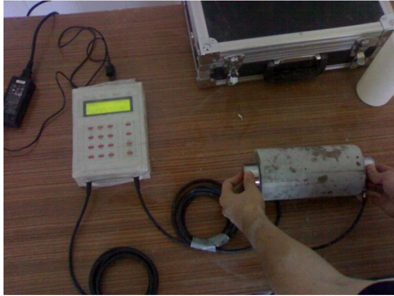
Őekil 4.6. Beton numuneye ultrasonik ses geirgenlik deneyi uygulanması
