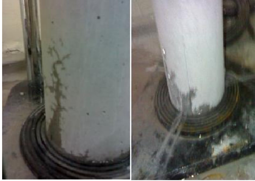
Şekil 4.4. a. Basınçlı suyun kılcal yollardan gidişi b. Basınçlı sudan dolayı çatlamış bir pomza içeriği yüksek numune
