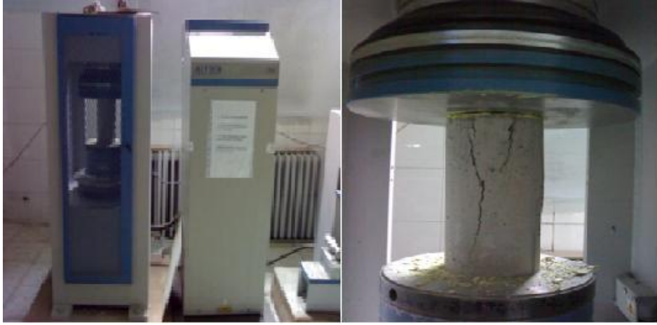
Şekil 4.2. a. Pres aletinin görünüşü b. Basınç dayanımı tayininde yük uygulanmış numune
