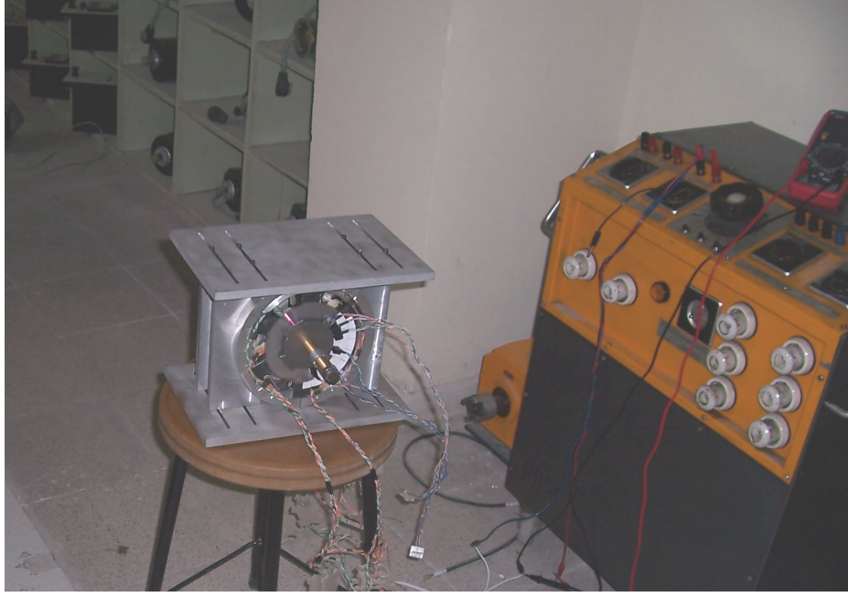
Şekil 5.10.a. Tasarımı yapılan 2 x 6/4 disk tipi ARM'ye ait deney düzeneği-1.
